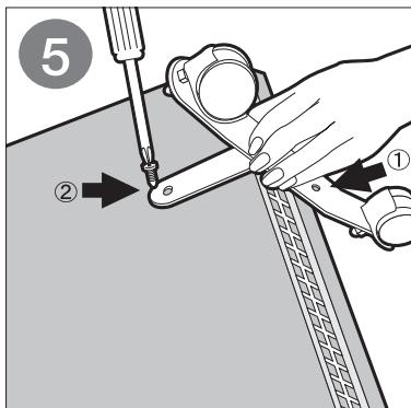
最初に①底面部を軽く締めて、次に②を締め、最後に両方を強く締めます。
