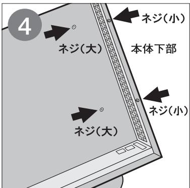
4箇所のネジを本体からドライバーで取り外してください。外したネジでキャスターを取付けます。
