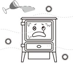
内部部品への水滴の付着や結露が絶縁の劣化をもたらし、火災・感電・故障の原因となります。
